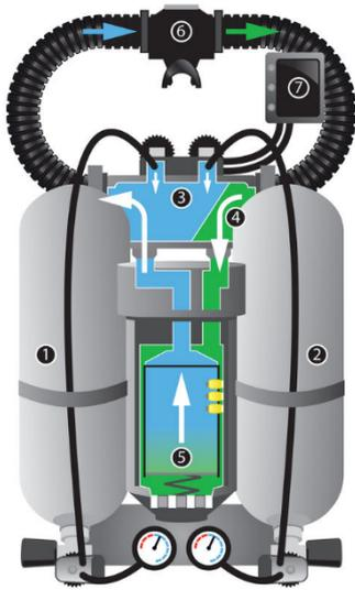
Moderne CCR's sind meist ähnlich aufgebaut. Sie bestehen grundsätzlich aus einer Sauerstoff- und einer Diluentflasche, zwei ersten Stufen, Gegenlunge, Atemkalkbehälter, Sauerstoffsensoren, O<sub>2</sub>-Partialdruckanzeigen, Atemschlange, Mundstück mit Schieber und Rückschlagventilen und verschiedene Möglichkeiten Sauerstoff und Diluent dem Loop hinzuzufügen.
